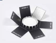
Falzen Sie die 6 rechteckigen Laschen der Objektivlinsen-Halterung nach vorne und schieben Sie das Teil mit der Linse voran in diejenige Öffnung des Objektivtubus [B2], bei der sich innen die graue Markierungen für Klebestellen befinden. Die Laschen müssen dabei genau bündig mit dem Rand des Objektivtubus sein. Sie bilden jetzt eine 24 mm tiefe schwarze Kammer, an deren Boden die Linse sitzt. Kleben Sie die Laschen in dieser Position fest.
